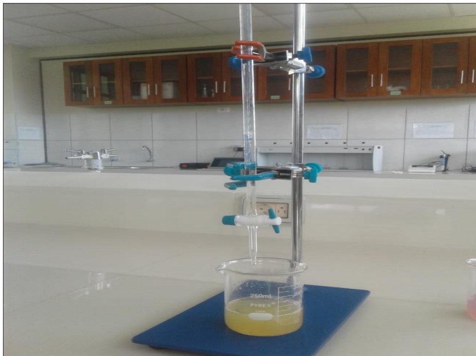
Imagen 2. Determinación de acidez mediante titulación.
