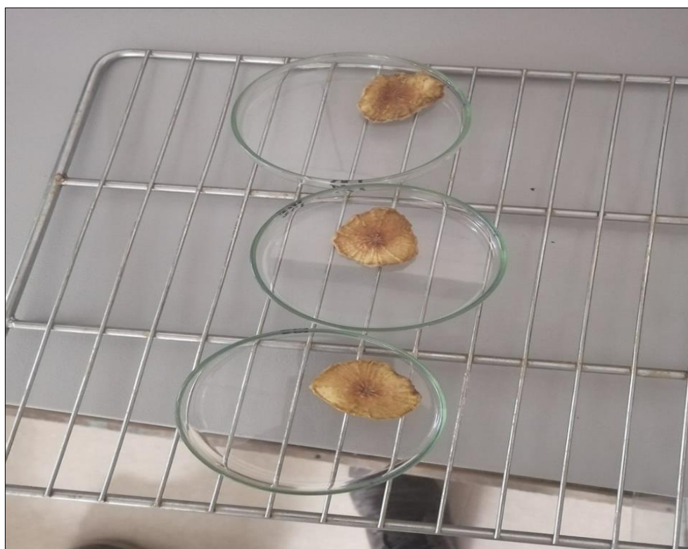
Imagen 3. Determinación de contenido de humedad por el método gravimétrico.
